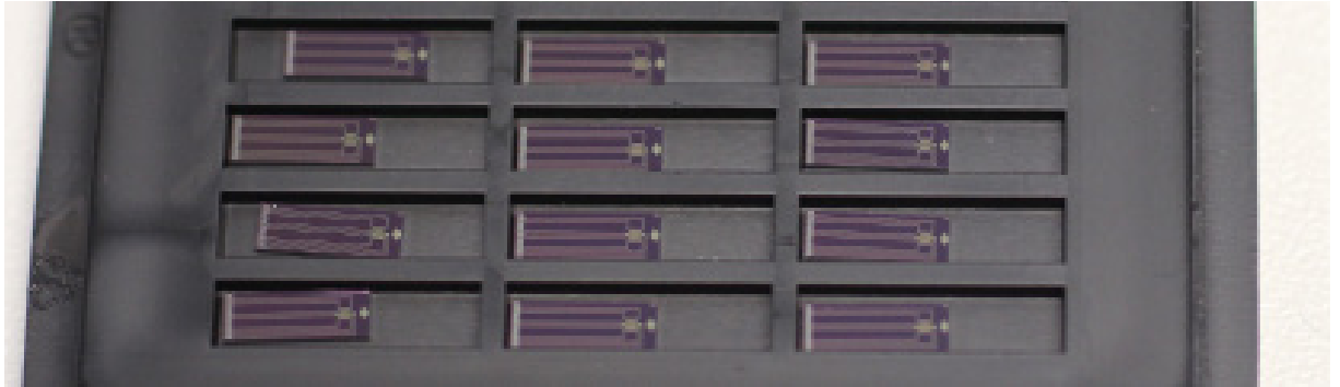
Fig. 7: SFS传感器在芯片托盘中
